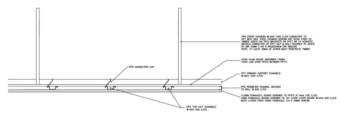
HUSH (UK) LTD SUSPENDED CEILING SYSTEM SIDE ELEVATION
